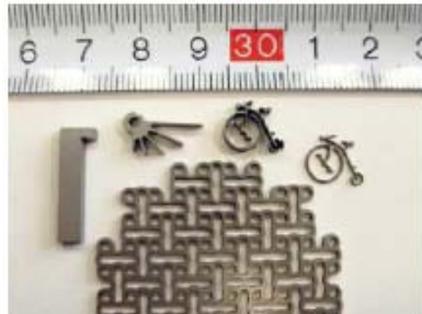
各式各样的微观结构（不锈钢和钛 0.6-2mm）
